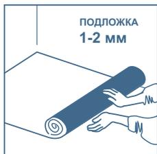
При монтаже на цементные основания удалите неровности с помощью выравнивающей смеси. Допустимое содержание влаги в цементных основаниях должно быть не более 2,5%, в ангидридных - не более 0,5%. На цементные основания рекомендуется предварительно расстелить плотную полиэтиленовую пленку толщиной 0,2 мм, с перекрытием стыков не менее 20 см и запуском на стену 2-3 см.
