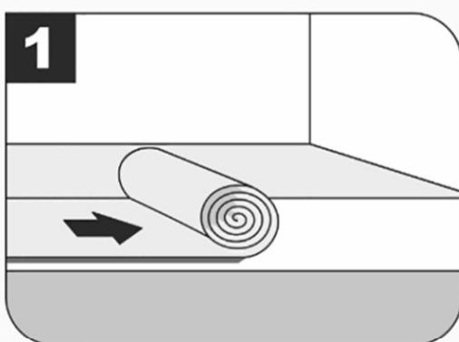
Для компенсации неровностей основания и обеспечения комфорта при эксплуатации расстилается подложка 1 - 1,5 мм.
