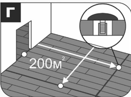
В помещениях площадью больше 200 кв.м необходимо предусмотреть деформационные зазоры не менее 6-8 мм. Рекомендуется использовать деформационные зазоры в проёмах дверей. После укладки кварцевого ламината деформационные зазоры закрываются накладным порогом.
