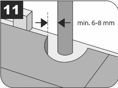
Необходимо соблюдать монтажные деформационные зазоры не менее 6-8 мм от края покрытия до выдающихся над поверхностью пола элементов (трубы, лестницы, колонны, перегородки, пороги и т. п.).
