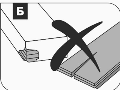
Пожалуйста, проверяйте купленные пачки: они должны быть целыми и не иметь повреждений. Поврежденные плашки нельзя использовать при укладке.
