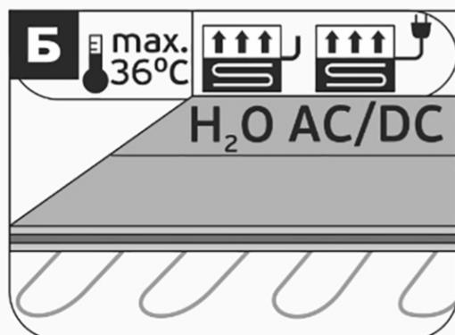
При использовании системы напольного водяного или электрического отопления учитывайте, что максимальная температура нагрева не должна превышать +36°C.
